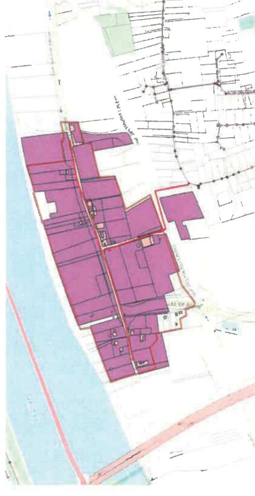
Le linéaire d'extension de réseau est de 700 m linéaire pour 16 abonnés, soit un ratio de 44 m linéaire par abonné. La valeur seuil de 50 m linéaire/abonné est respectée. Cette extension ne nécessite pas de poste. Le coût des travaux est estimé à 28 000 € par abonné
