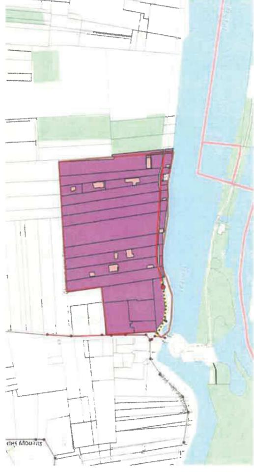
Le linéaire d'extension de réseau est de 270 m linéaire pour 8 abonnés, soit un ratio de 34 m linéaire par abonné. La valeur seuil de 50 m linéaire/abonné est respectée. Cette extension nécessite l'installation d'un poste de refoulement. Le seuil d'un poste pour au moins 5 abonnés est respecté.
